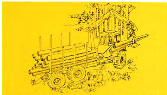
Trasporto di tronchi o di legno da pasta con gru e montanti laterali.
