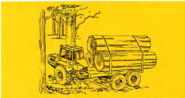
Il 860 TC equipaggiato per il trasporto di grossi tronchi, con alloggiamento sul telaio, montanti laterali e argano.
