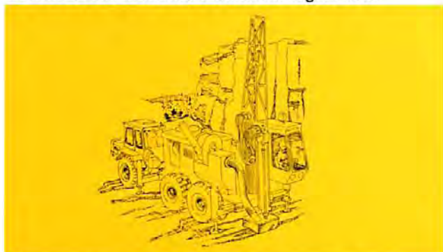
Attrezzatura di trivellazione per lavori di prospezione.
