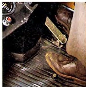
Pedale di innesto e disinne- sto rapidi del blocco dei differenziali.
