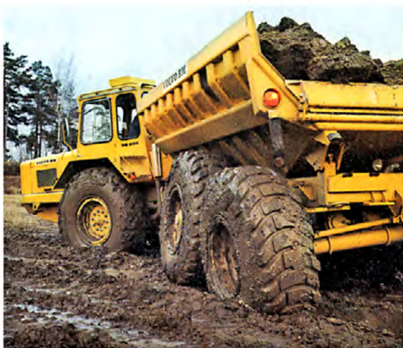
L'asse motore del tandem posteriore è predisposto per i terreni molto accidentati. E' munito di riduttori planetari ai mozzi e di dispositivo di bloccaggio del differenziale.
