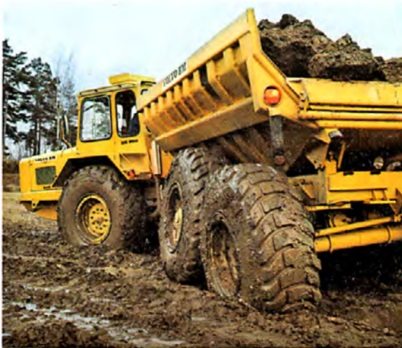
El eje motriz del bogi está construido para transportes exigentes campo a través. Tiene reductores de cubo y bloqueador de diferencial.
