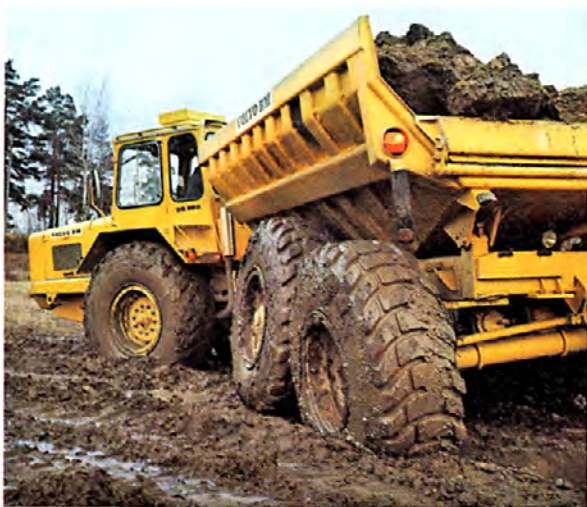
L'essieu moteur des tandems est conçu pour une conduite sur terrain difficile. Il comporte une réduction finale dans les moyeux et un blocage de différentiel.
