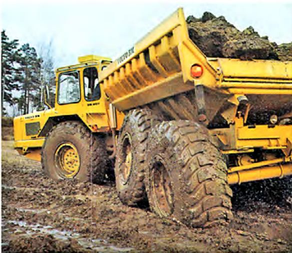
De aandrijvende as van de bogie is berekend op rijden in moeilijk terrein en is uitgerust met naafreductie en differentieelslot.
