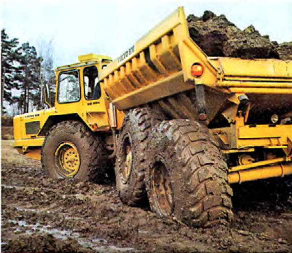
Die Antriebsachse des Doppelachsaggregats ist für schwierigstes Gelände gestaltet. Sie hat Nabenendgetriebe und Differentialsperre.
