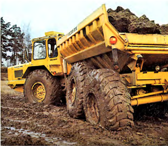
Telin vetoakseli on rasittavaa maastoajoa varten tehty. Siinä on napavälitykset ja tasauspyörästöluukko.
