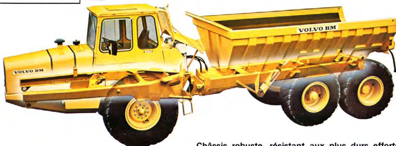
Le vérin de traction reliant l'élément porteur à l'élément tracteur autorise un pivotement illimité.
