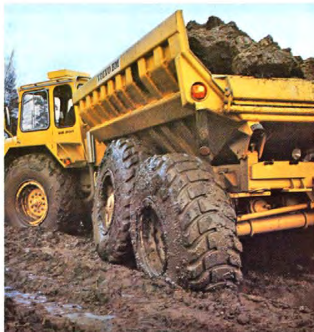
Le système de tandems élimine littéralement les accidents de terrain et réduit donc au minimum les pertes de contenu de la benne.
