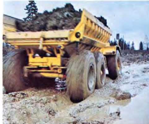
Les 4 roues motrices et les blocages de différentiels peuvent être crabotés et décrabotés en marche, ce qui évite donc les pertes de vitesse en terrain difficile.
