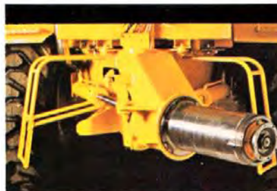
Le vérin de traction reliant l'élément porteur à l'élément tracteur autorise un pivotement illimité.
