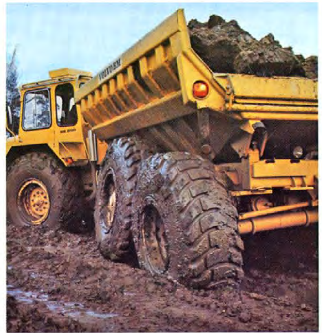
Minimalt spild, lastkarret "flyder frem" over den terrænudjævnende boggi.
