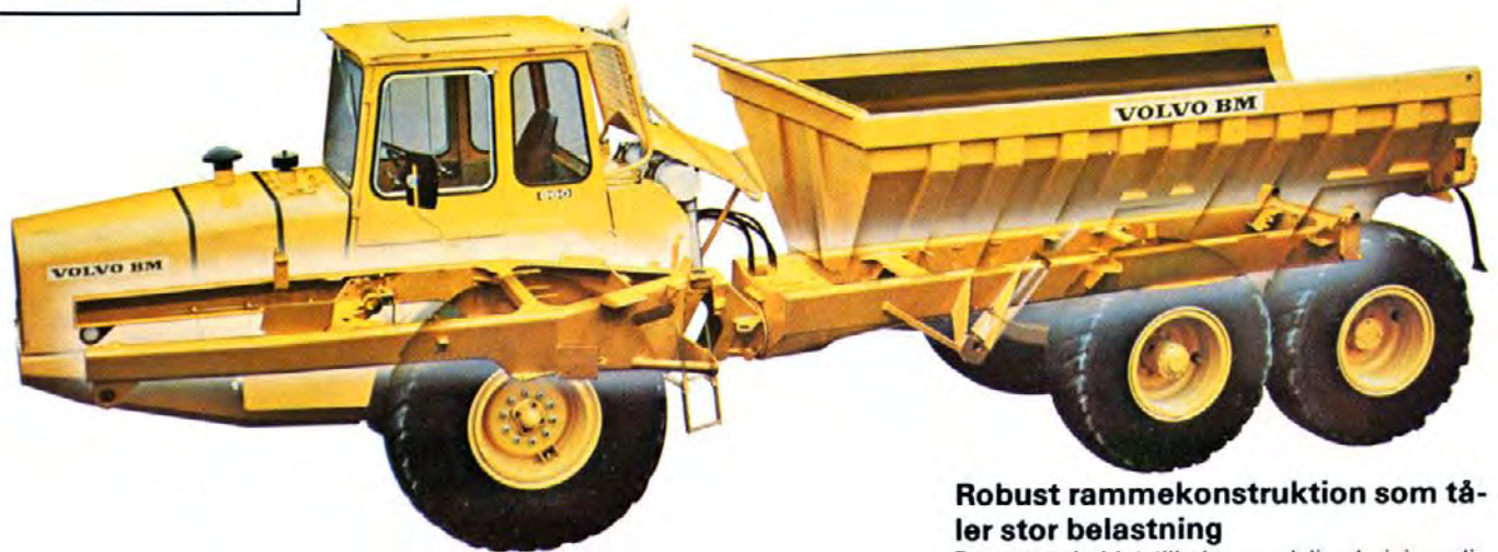
Trækcyllinder som forbinder motor- og lasteenheder.
