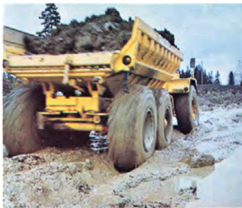
4-hjulstrækket såvel som differentialespærrene kobles til og fra under kørslen – maskinen beholder derfor farten, når den går ind i dårlige terræforhold.
