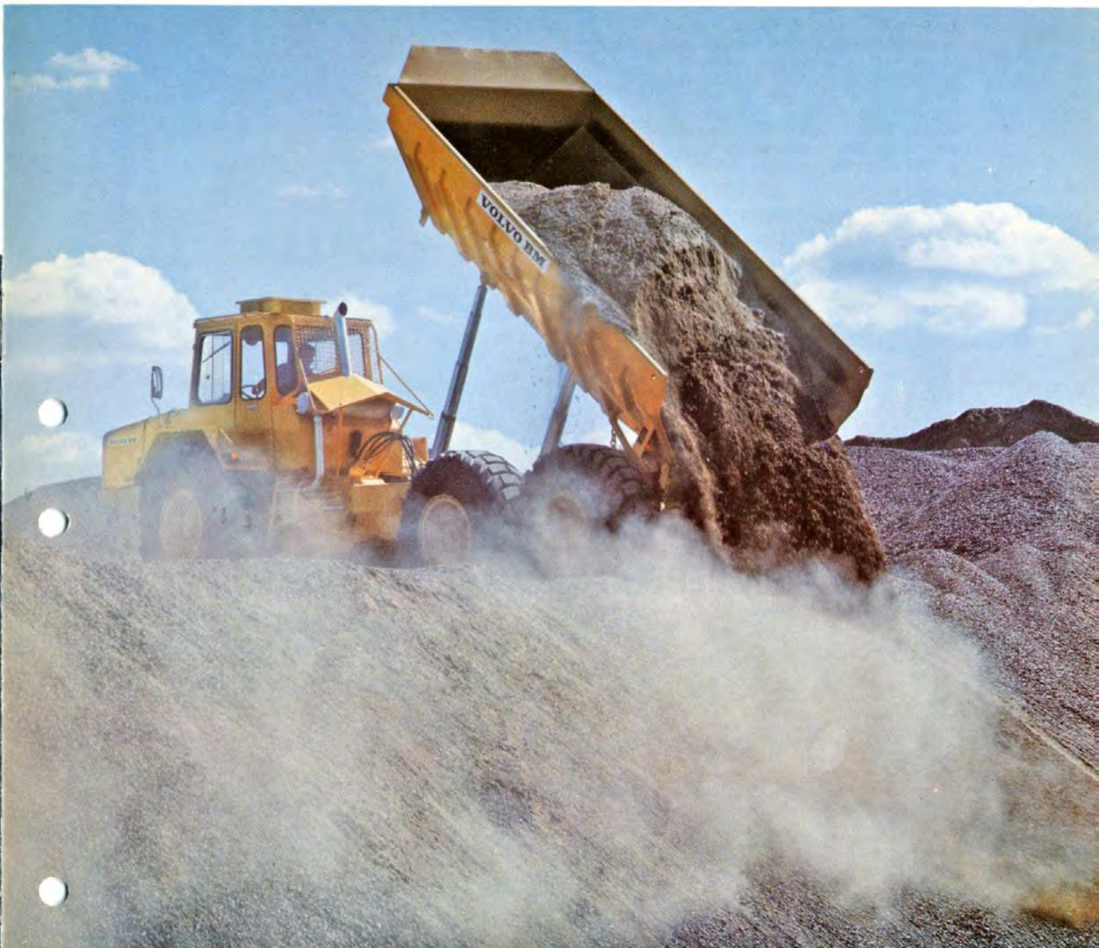
Hurtig tømning ved en stor tipvinkel – 70° og en effektiv hydraulik.
