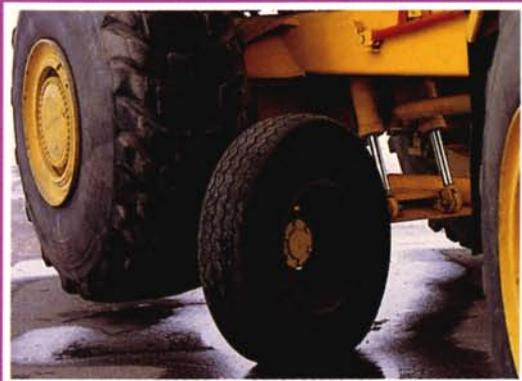
Für den 5350 B 4×4 ist eine spezielle Schnelldrehvorrichtung von Volvo BM entwickelt worden. Diese Ausrüstung besteht aus einer Zwischenachse, die mit Stützrädern versehen ist und von der Kabine aus hydraulisch betätigt werden kann. Der Anhänger läßt sich somit in weniger als 30 Sekunden leicht und einfach um ganze 90° schwenken. Mit dieser Ausrüstung ist der 5350 B 4×4 vorzugsweise auch auf engstem Raum überaus leistungsfähig einsetzbar.
