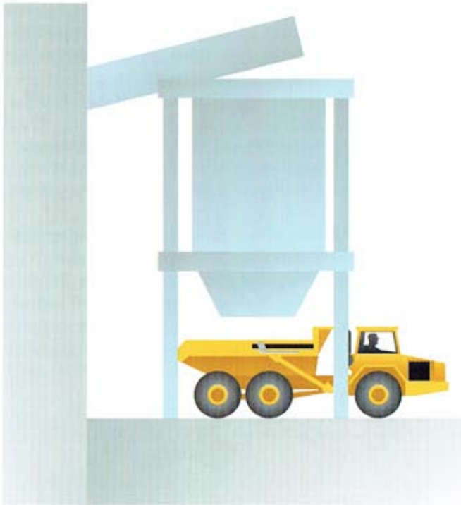
Knicklenker sind wendig und lassen sich leicht in die richtige Ladeposition manövrieren.
