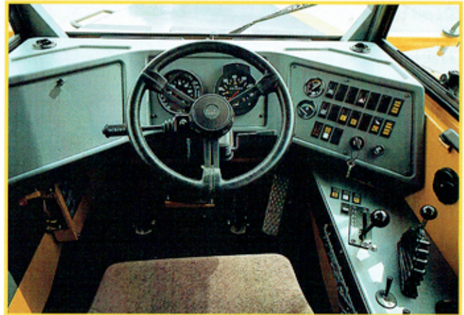
Der Fahrer sitzt dort, wo sich die Maschinenbewegungen am wenigsten bemerkbar machen, nämlich mitten zwischen den Vorderrädern und genau über der Vorderachse.
