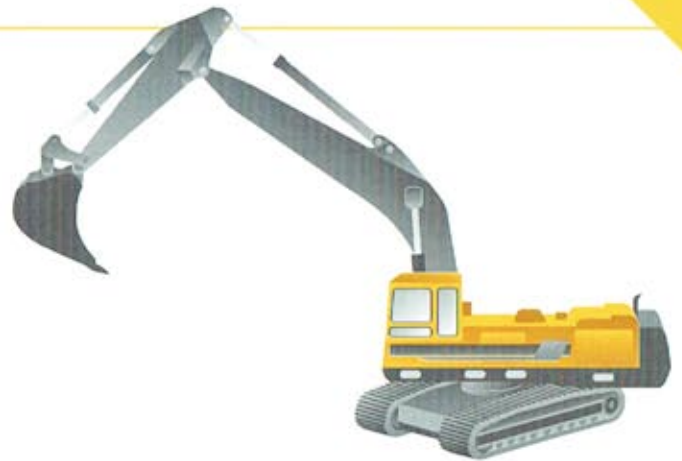
Um hohe Produktivität zu erzielen, müssen Lade- und Transportgeräte gut aufeinander abgestimmt sein. Bagger sollten mit 3 - 5 Löffelfüllungen eine volle Zuladung erzielen. Der Transporter sollte nicht gezwungen sein, auf halbvolle Löffel zu warten. Richtige Ladegeräte und Löffelgrößen verringern die Gesamtkosten.
