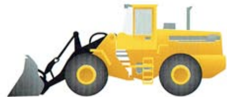
Ein Radlader eignet sich gut für Schüttgut. Er ist äußerst wendig und schnell. Die breiten Schaufeln sind sehr gut auf die Mulden der Transportfahrzeuge abgestimmt.
