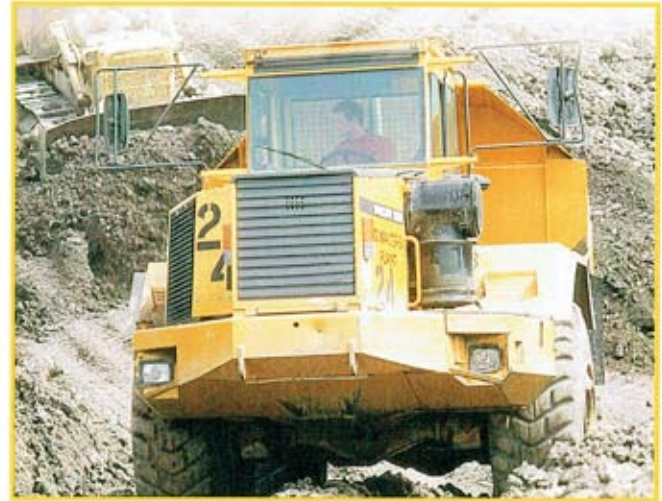
Ein Knicklenker ist ein besonders vielseitiges Transportfahrzeug. Seine guten Eigenschaften sowohl auf Baustraßen wie im Gelände machen ihn zur idealen Maschine für unterschiedlichste Einsatzbedingungen.
