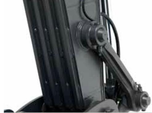
• Balancier protégé avec fixation de godet renforcée, en option.
