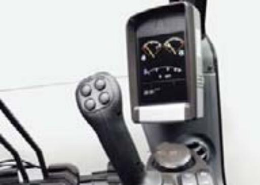
• LCD-Farbmonitor und Bedienhebel – ergonomisch günstig angeordnet.
