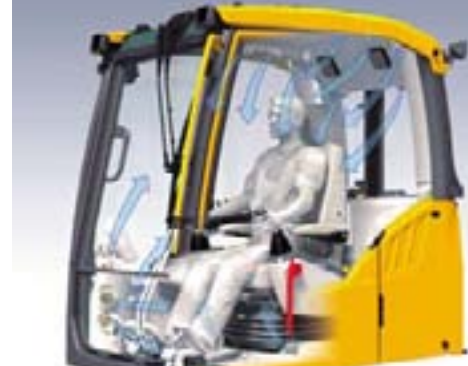
• Branschens bästa värme-/kylkapacitet med 14 ventiler.
