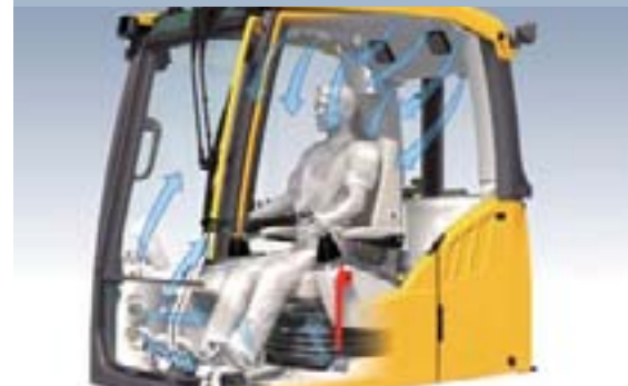
• Grazie alle 14 ventole la capacità di riscaldamento/raffreddamento è maggiore.
