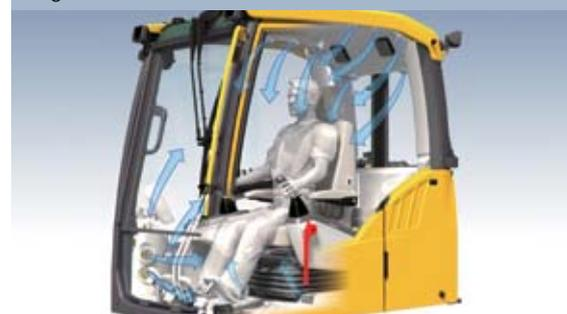
• Capacité de chauffage et de refroidissement maximum avec 14 bouches d'air.
