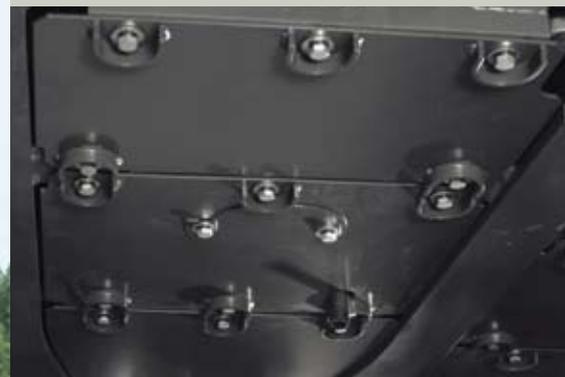
• Les boulons inférieurs sont spécialement protégés pour résister à de fortes contraintes.
