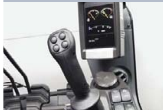
• LCD-Farbmonitor und Bedienhebel – ergonomisch günstig angeordnet.
