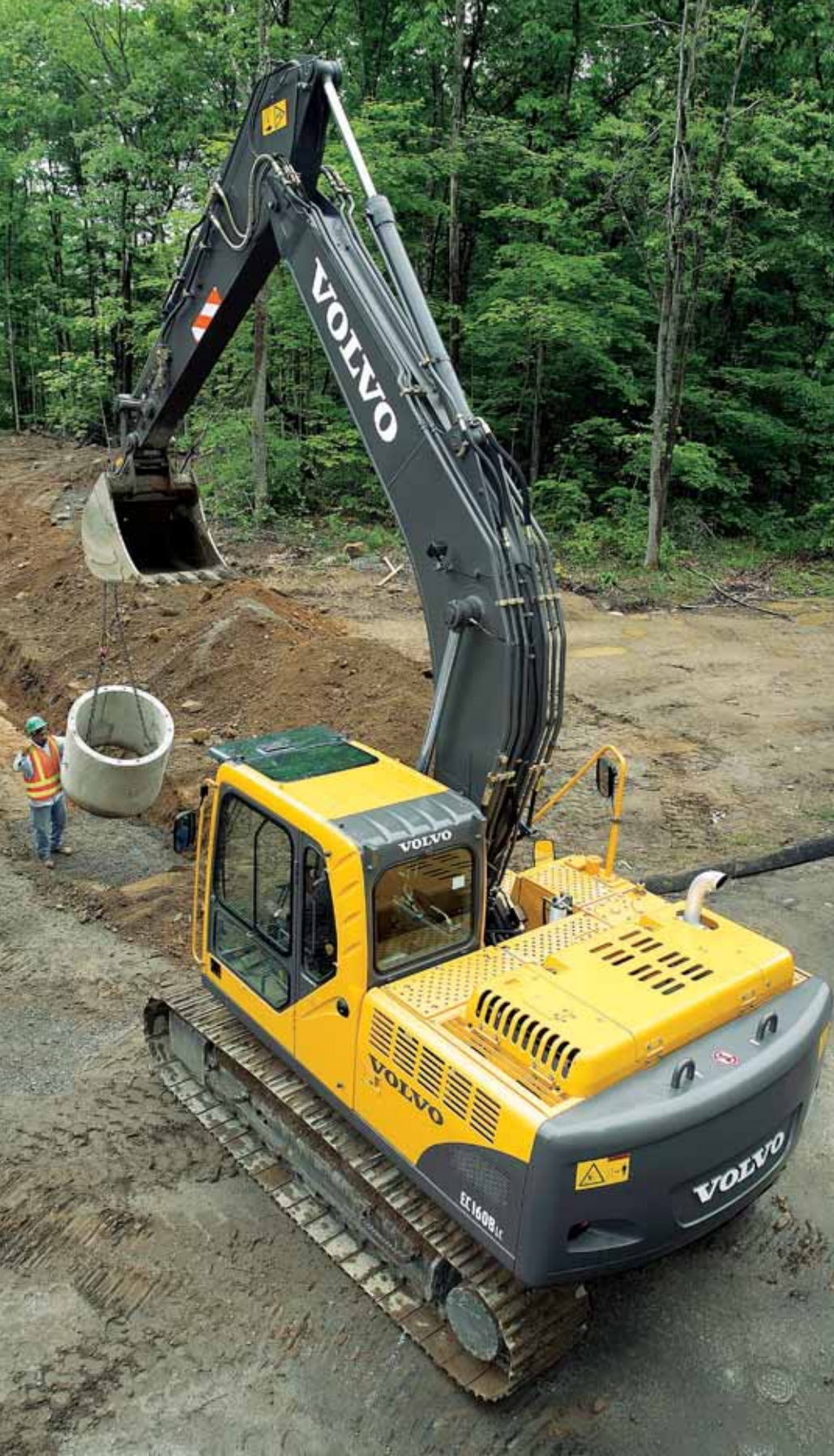
Manövrering: hydraulik som möjliggör precisionsplacering.
