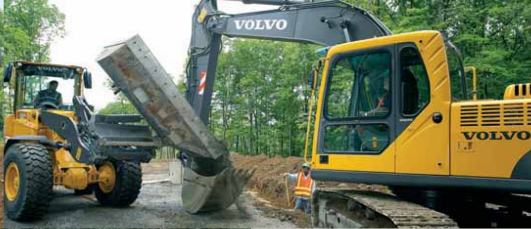
Manövrering: hydraulik som möjliggör precisionsplacering.
