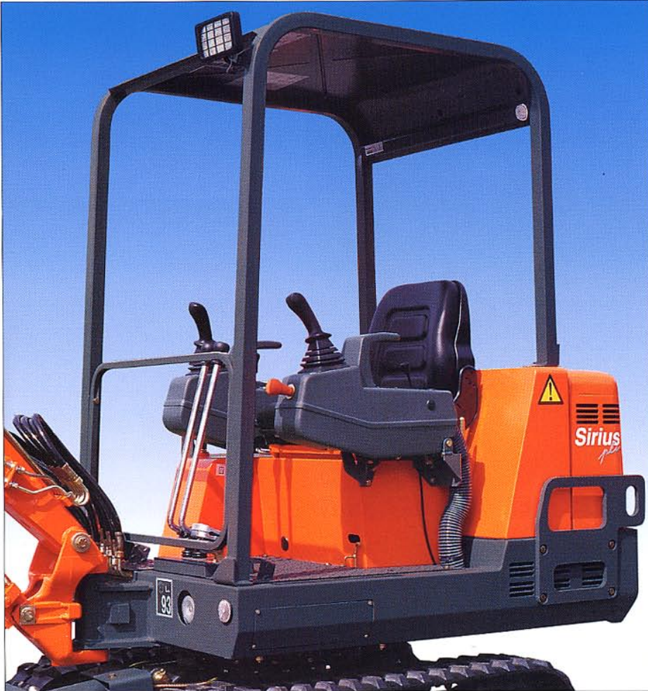
Pel-Job's störbåge, som har fyra kraftiga hörnstolpar ger ett utmärkt skydd. En fullt inglasad hytt finns som tillval.
