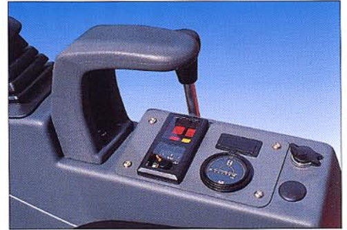
På instrumentpanelen finns bränslemätare och timräknare, indikatorlampor för oljetryck, kylvätsketemperatur och batteriladdning. Där finns också ett uttag för sladdlampa.
