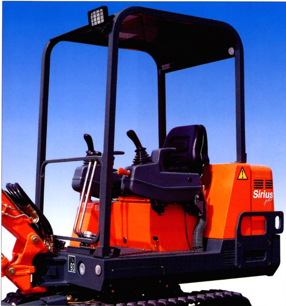
Le canopy Pel-Job à quatre montants pour plus de sécurité est équipé d'un toit largement couvrant pour une protection du conducteur parfaite par tous les temps.
