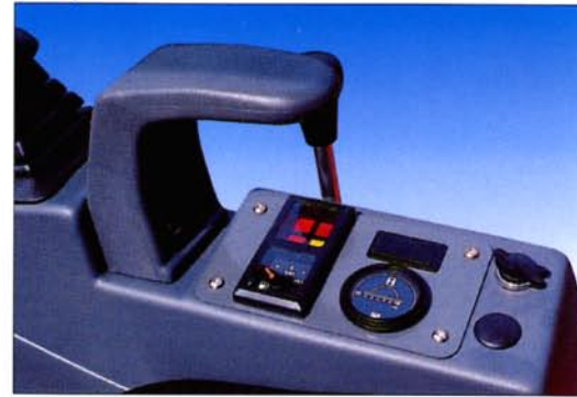
Le tableau de bord regroupe la jauge à carburant, le compteur horaire et les voyants de pression d'huile, de température d'eau et de charge de la batterie. Une prise électrique permet de brancher une lampe baladeuse.
