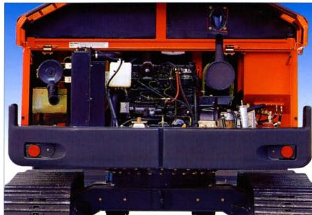
Le capot arrière à ouverture totale dégage un large accès sur le moteur et sur les pompes hydrauliques. Tous les points d'entretien et de contrôle sont idéalement situés à portée de la main.
