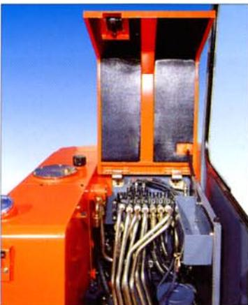
Un large capot central dégage une plate-forme de service où sont regroupés tous les composants hydrauliques de la machine. L'accès aux distributeurs, au joint tournant et au moteur d'orientation est immédiat, ce qui facilite grandement toutes les opérations de maintenance.
