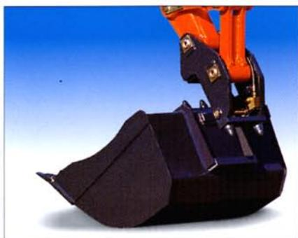
Une exclusivité Pel-Job : le système d'attache rapide permet de changer d'accessoire ou de godet sans quitter le poste de conduite. Apprécié de tous les utilisateurs, ce dispositif offre un gain de temps et de confort appréciable sans modifier les performances ni la cinématique du godet.
