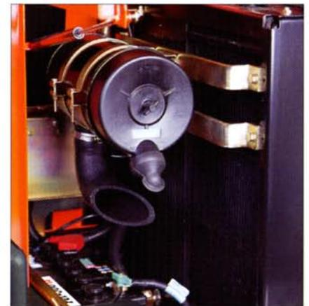
Les radiateurs du moteur et du circuit hydrauliques sont placés côte à côte pour faciliter leur nettoyage. La batterie et le filtre à air sont eux aussi très facilement accessibles.
