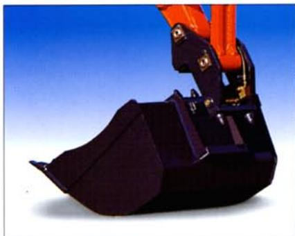
Le système d'attache rapide permet de changer d'accessoire ou de godet sans quitter le poste de conduite. Apprécié de tous les utilisateurs, ce dispositif offre un gain de temps et de confort appréciable sans modifier les performances ni la cinématique du godet.
