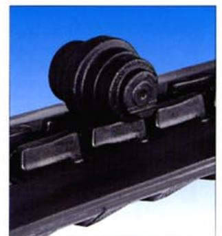
Le confort de roulement est nettement amélioré grâce au profil des chenilles et à la position alternée des guides qui assure un contact permanent avec les galets.
