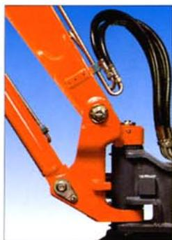
Tous les flexibles de l'équipement sont libres et gainés donc sans frottement ni usure et sont raccordés en pied de flèche pour un remplacement très rapide si nécessaire. La flèche est montée sur un pivot articulé à double chape qui permet le montage d'un axe long et assure une plus grande rigidité de la liaison flèche-châssis. La tige du vérin de flèche est intégralement protégée contre les chocs éventuels par un robuste blindage.
