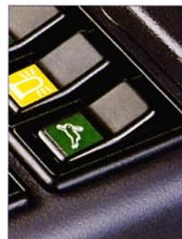
L'EB 406 est équipée en standard de deux vitesses de translation dont une vitesse rapide pour accélérer les déplacements de la machine sur le chantier.
