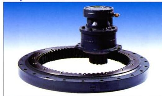
Une exclusivité Pel-Job : le moteur d'orientation lent à pistons radiaux. Ce moteur dispose d'un très fort couple au démarrage, pour des manoeuvres tout en souplesse et entraîne directement la couronne sans réducteur mécanique. Résultat : moins de pièces en mouvement et donc moins de risques d'usure. Le frein hydraulique automatique intégré au moteur d'orientation immobilise la tourelle dans toutes les positions et garantit une sécurité de travail optimale même en dévers.
