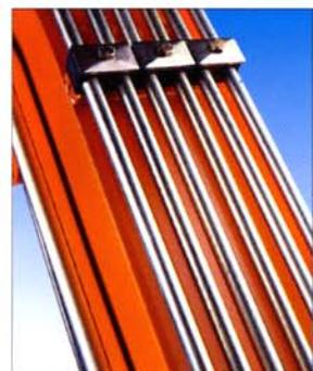
Une protection très efficace contre la corrosion : toute la boulonnerie, les axes et les tuyaux hydrauliques sont zingués et bichromatés.
