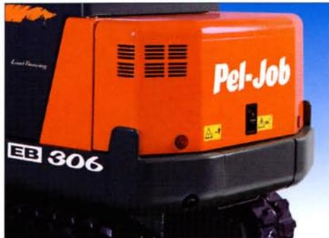
Parce que certains chocs sont malheureusement inévitables, le contrepoids enveloppant protège l'arrière de la machine. Le capot en acier est monté en retrait par rapport au contrepoids pour améliorer sa protection.
