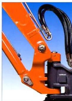
Tous les flexibles de l'équipement sont libres et gainés donc sans frottement ni usure et sont raccordés en pied de flèche pour un remplacement très rapide si nécessaire. La flèche est montée sur un pivot aticulé à double chape qui permet le montage d'un axe long et assure une plus grande rigidité de la liaison flèche-châssis. La tige du vérin de flèche est intégralement protégée contre les chocs éventuels par un robuste blindage.
