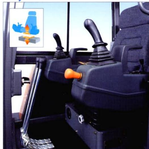
Les commandes hydrauliques sont assistées et très progressives pour plus de souplesse et de précision. Les nouveaux manipulateurs ergonomiques Pel-Job tombent bien en main et sont complétés dans leur prolongement par des accoudoirs latéraux qui assurent une position de conduite naturelle et très confortable.
