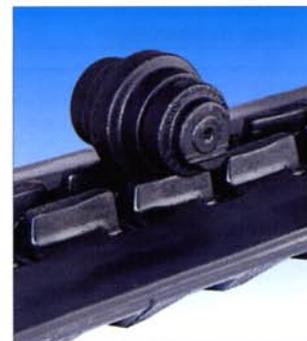
Le confort de roulement est nettement amélioré grâce au profil des chenilles et à la position alternée des guides qui assure un contact permanent avec les galets.
