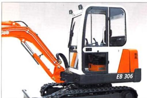
Nouvelle cabine panoramique traitée cataphorèse (anti corrosion). La baie vitrée avant sans traverse équipée d'un pare-brise bombé projetable dans le toit et la vitre inférieure démontable assurent une visibilité optimum. Un système de désembuage du pare-brise permet un travail précis et efficace en toute sécurité dans toutes les conditions d'utilisation.
