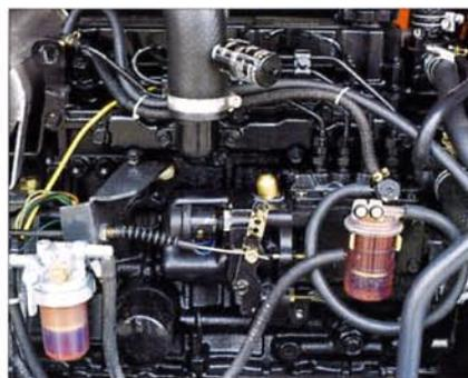
Filtre à gas-oil très facilement accessible. Filtre et pré-filtre pour assurer une parfaite protection de l'alimentation gasoil. Circuit retour très accessible sans démontage du capot du moteur d'où un accès facile à la batterie. Accès facilité pour le nettoyage des radiateurs d'huile et d'eau. Accès facile à la batterie et à la pompe de graissage pour la maintenance.
