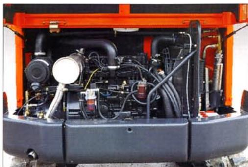
Nouveau moteur diesel MITSUBISHI 3 cylindres à injection indirecte refroidi par eau. Pompe à débit variable "Load Sensing" pour optimiser les performances, la précision et la souplesse d'utilisation accouplée à une pompe à débit fixe pour plus d'indépendance des mouvements. Faible niveau sonore, consommation réduite, sécurité d'utilisation avec arrêt automatique en cas de problème électrique font de ce moteur le plus performant de sa génération.
