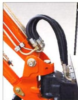
Flexibles très accessibles pour faciliter la maintenance et centrés au niveau de la flèche : meilleure visibilité et sécurité d'utilisation (pas de risques d'accrochage).
