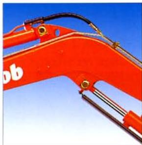
Conçu par ordinateur puis validé par des essais de résistance et d'endurance, le nouveau concept de flèche est d'une très grande solidité grâce au positionnement des soudures sur les zones de faibles contraintes.
