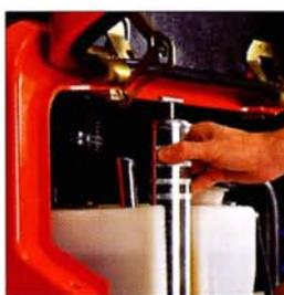
Le réservoir de gasoil est en polyéthylène transparent pour contrôler facilement le niveau de carburant pendant le remplissage. Il incorpore également un logement très pratique pour la pompe à graisse qui reste ainsi toujours à portée de main.
