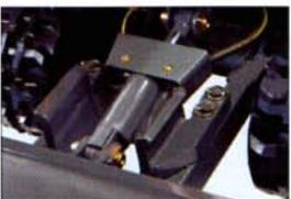
La lame dispose de deux élargisseurs qui se montent et se démontent très rapidement sans outil. En position étroite, ceux-ci sont placés sur des supports prévus à cet effet sur les bras de lame.
