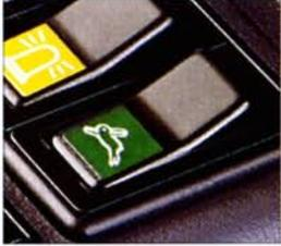
Les nouvelles EB 150 et EB 200 XT et XTV sont équipées en standard de deux vitesses de translation dont une vitesse rapide pour accélérer les déplacements de la machine sur le chantier.
