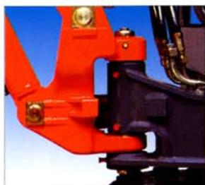
La flèche est montée sur un pivot articulé à double chape qui permet le montage d'un axe long et assure une plus grande rigidité de la liaison flèche-châssis.
