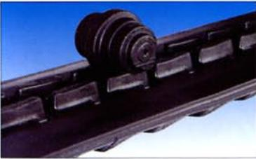
Le confort de roulement est nettement amélioré grâce au nouveau profil des chenilles et à la position alternée des guides qui assure un contact permanent avec les galets.
