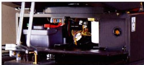
Une large trappe donne accès à la batterie étanche sans entretien, aux fusibles et au filtre hydraulique.
