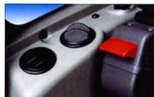
Le chauffage puissant se règle directement dans la cabine et permet un désembuage rapide des vitres grâce aux buses orientables.
