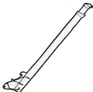
Kranarm* hydrauliskt utskjutbar 1,2 m.
