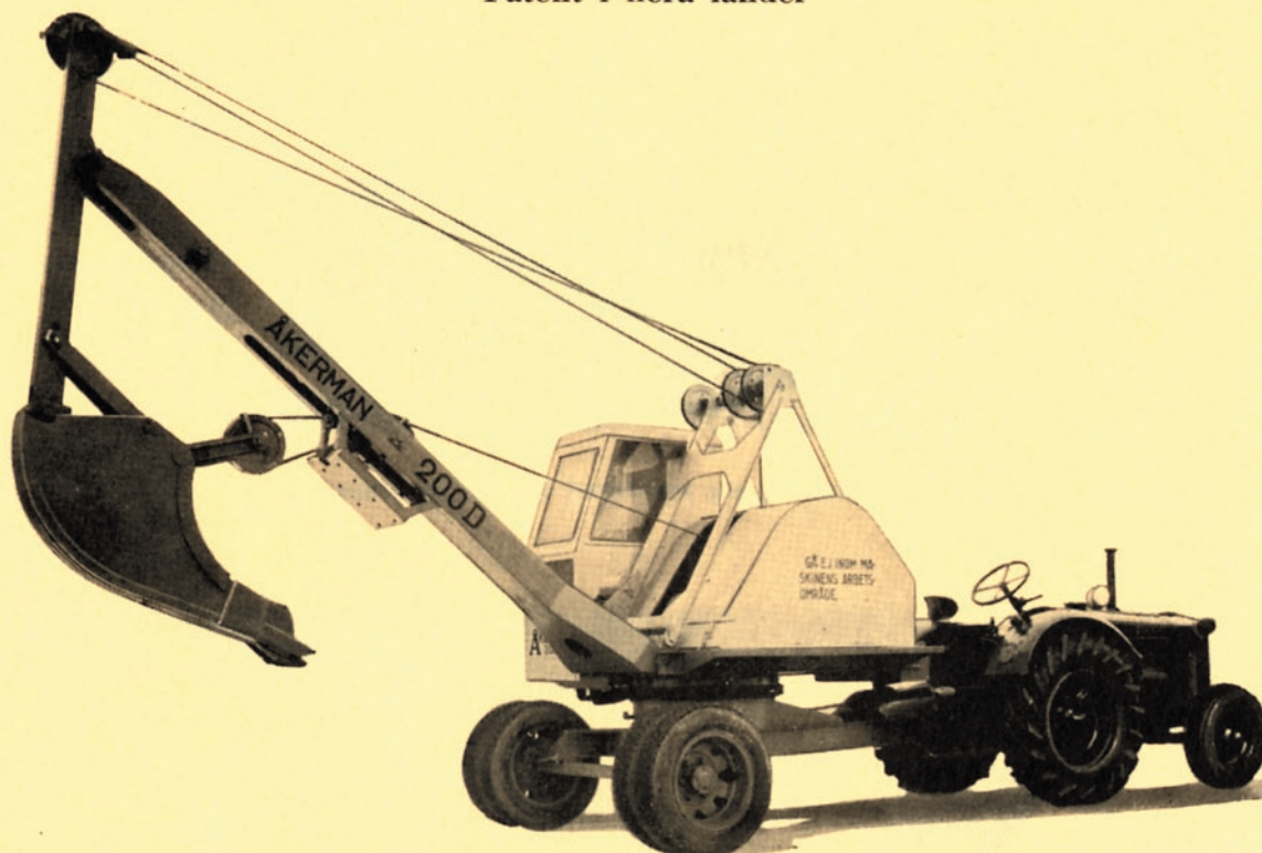
Fig. 1. 200 D, utrustad för täckdikning.
