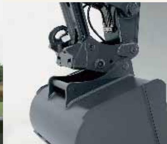
• Schnellwechsler: einfacher Gerätewechsel von der Kabine aus.
