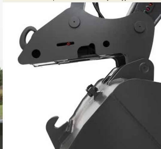
• Pikakiinnityksen avulla työvälineen vaihto käy nopeasti ohjaamosta.
