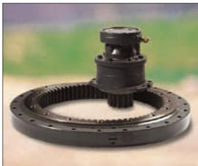
Una exclusividad : el motor de orientación de pistones radiales. El motor cuenta con un muy elevado par de arranque, para maniobras muy suaves, y acciona directamente la corona sin reductor mecánico. El resultado es un menor número de piezas en movimiento, y por tanto un menor riesgo de desgaste. El freno hidráulico automático, integrado en el motor de orientación, inmoviliza la torreta en cualquier posición y proporciona una óptima seguridad en el trabajo, incluso en pendiente.
