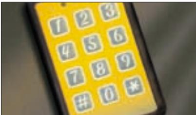
Un teclado antirrobo, disponible como opción, permite bloquear el arranque de la máquina y las principales funciones hidráulicas.
