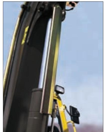
Latiguillos con sobrefunda (seguridad para el conductor) montados libremente a pies de flecha : Acceso y mantenimiento fáciles, mejor visibilidad y seguridad de utilización (sin riesgos de enganches). La pluma está montada sobre un pivote articulado de doble horquilla que permite el montaje de un eje largo y asegura una mayor rigidez de la unión pluma-chasis. El vástago del cilindro de pluma está totalmente protegida contra los choques eventuales por un sólido blindaje.
