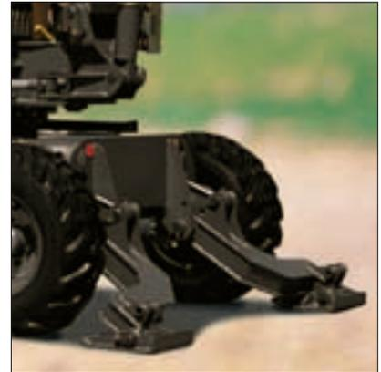
La EW70 viene equipada de serie con una robusta hoja accionada por dos cilindros con válvulas de seguridad, que puede ser sustituida opcionalmente por dos estabilizadores con mandos independientes a los que se les puede añadir una hoja amovible.
