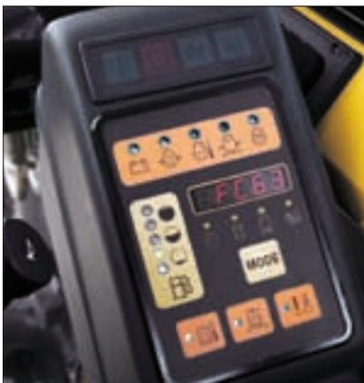
Der in den EW70 integrierte Bordcomputer PUMA überwacht ständig alle wesentlichen Maschinenfunktionen und informiert den Fahrer unverzüglich im Falle einer Störung. Der Fahrer kann durch diese automatische Kontrolle seine gesamte Aufmerksamkeit auf die Bedienung der Maschine richten.
