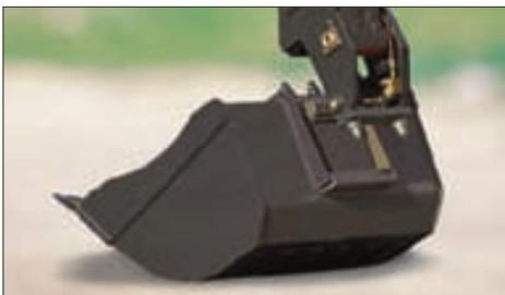
Das Werkzeug-Schnellwechselsystem, das ein Auswechseln des Zubehörs ohne Verlassen des Führerstandes ermöglicht: Von allen Benutzern sehr geschätzt, bietet diese Vorrichtung einen beachtlichen Zeitgewinn und ein Plus an Komfort, ohne die Kinematik und damit die Leistung des Löffels zu beeinträchtigen.
