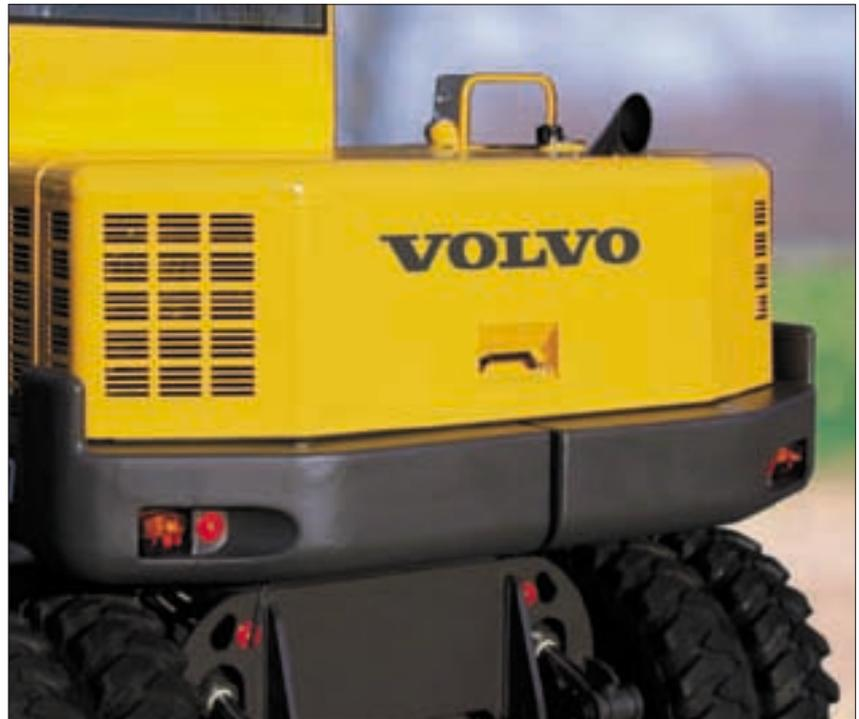
Die abgerundete Form des Kontergewichtes schützt die Heckpartie und ermöglicht Arbeiten auf engstem Raum.
