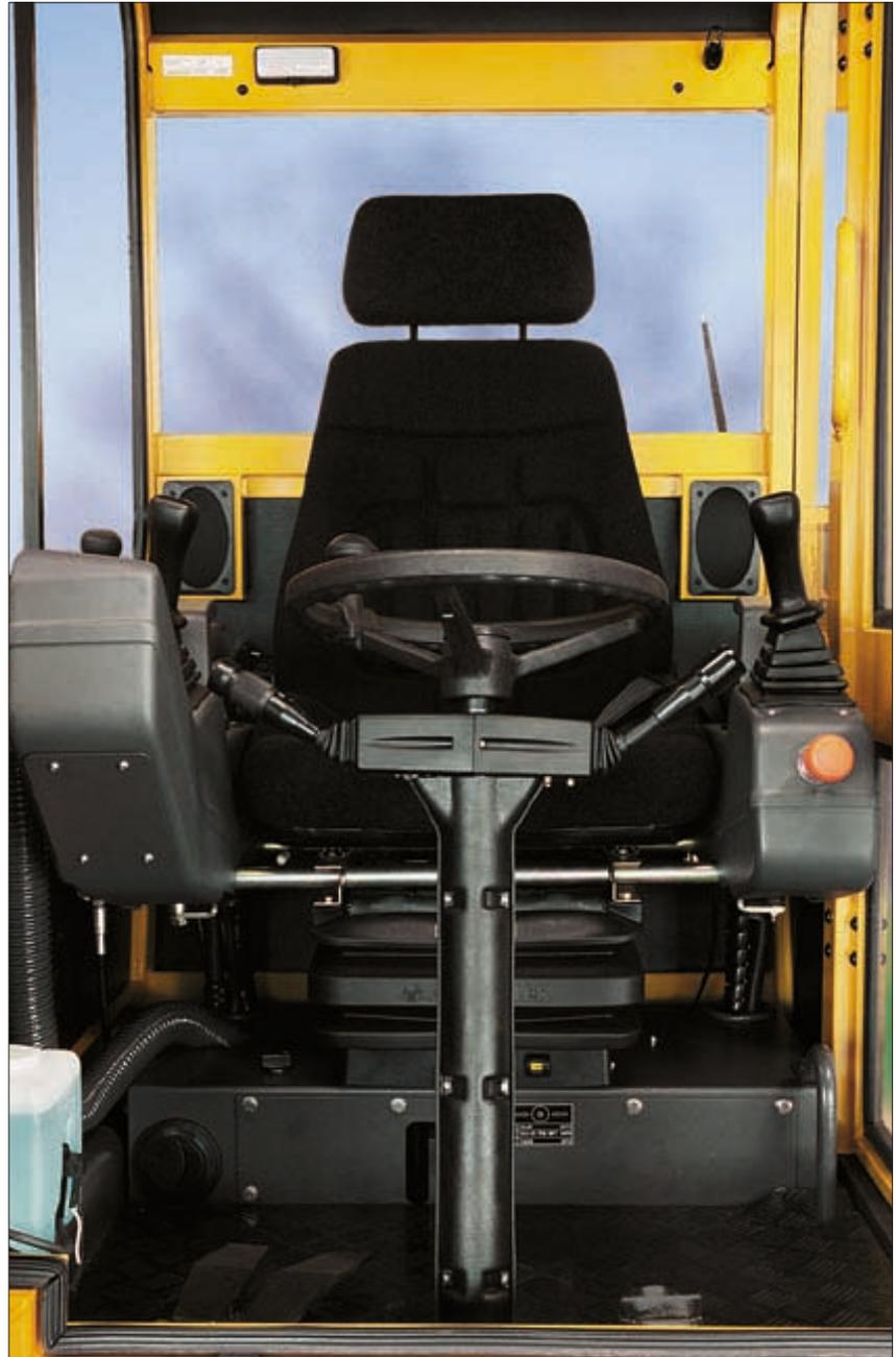
Ergonomisch geformte Bedienungshebel: großer Zeitgewinn, da man die Maschine sehr gut im Griff hat und alle Bewegungen sehr präzise sind. Gefederter und vielfach verstellbarer Komfortfahrersitz, Einstellungen unabhängig zu den Bedienelementen.
