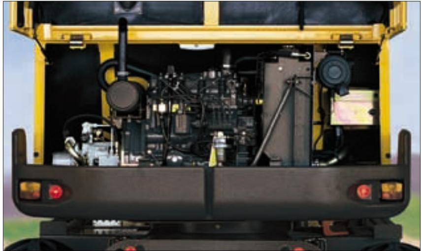
El capó trasera con apertura total libera un amplio acceso al motor y a las bombas hidráulicas. Todos los puntos de mantenimiento y de control están idealmente ubicados al alcance de la mano.
