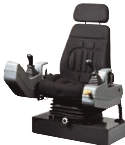
Las consolas laterales que llevan los mandos hidráulicos son solidarias con la suspensión del asiento : la precisión de la conducción queda independiente de los movimientos de la máquina, y el conductor está seguro de encontrar una posición de conducción idealmente adecuada a su morfología.
