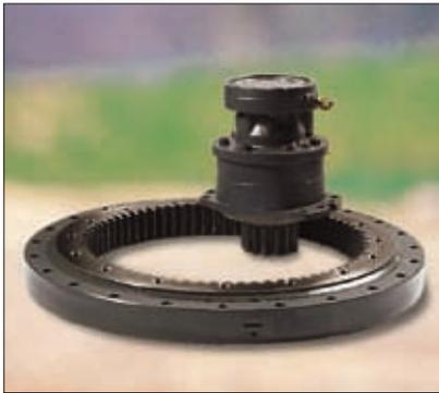
Una exclusividad : el motor de orientación de pistones radiales. El motor cuenta con un muy elevado par de arranque, para maniobras muy suaves, y acciona directamente la corona sin reductor mecánico. El resultado es un menor número de piezas en movimiento, y por tanto un menor riesgo de desgaste. El freno hidráulico automático, integrado en el motor de orientación, inmoviliza la torreta en cualquier posición y proporciona una óptima seguridad en el trabajo, incluso en pendiente.
