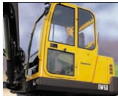
Una protección muy eficaz contra la corrosión : todos los pernos, ejes y tubos hidráulicos están galvanizados con zinc y bicromatados para que su mini-excavadora mantenga durante largos tiempos el aspecto del primer día.
