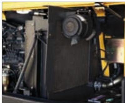
Los radiadores del motor y del circuito hidráulico están situados uno al lado del otro para facilitar su limpieza. La batería y el filtro de aire también gozan de fácil acceso.
