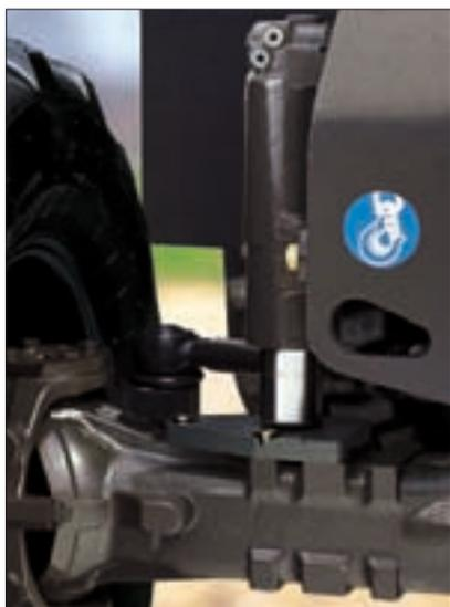
El eje delantero director es oscilante con un desplazamiento de 15° para poder pasar por cualquier terreno. Un dispositivo hidráulico de bloqueo de la oscilación garantiza la perfecta estabilidad de la excavadora en todas las posiciones.
