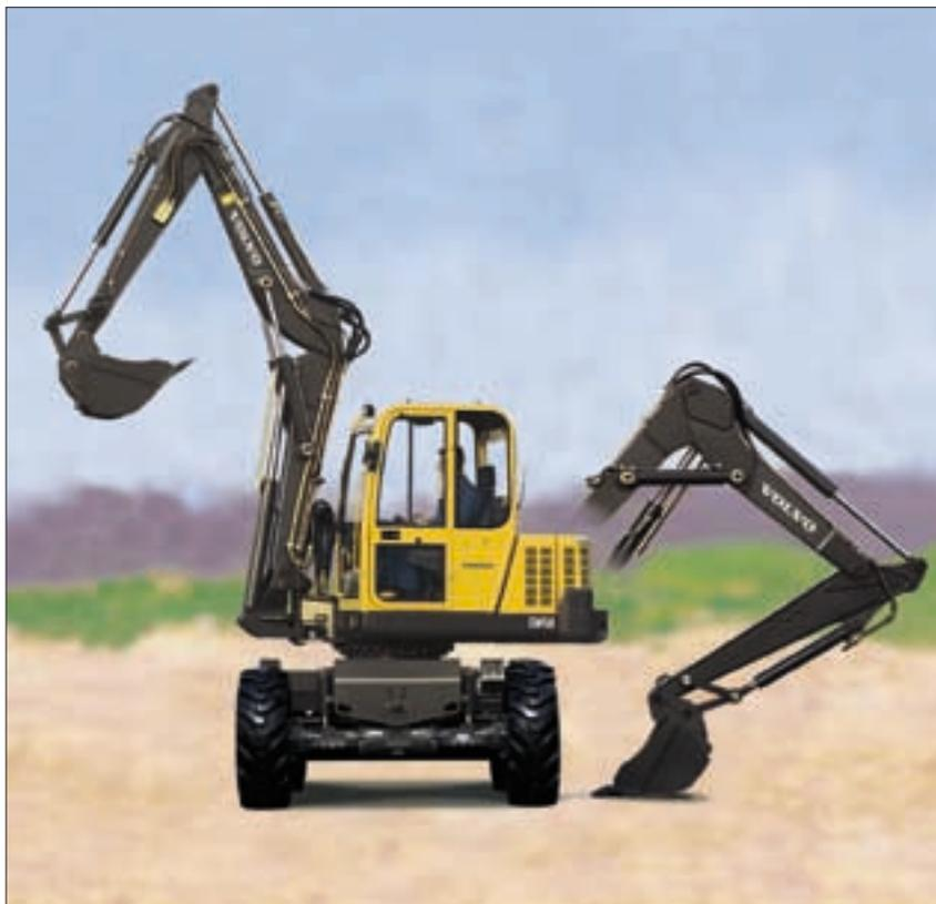
Il braccio a triplice articolazione aumenta la polivenza dell'EW50 : permette di ridurre l'ingombro dell'attrezzatura e di posizionare la benna su di una maggiore area al suolo, anche in prossimità della macchina stessa.
