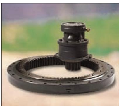
Un'esclusività: il motore d'orientazione lento a pistoni radiali. Questo motore dispone di una coppia molto forte all'avviamento, per manovre in flessibilità e avanza direttamente la ralla senza riduttore meccanico. Risultato: meno pezzi in movimento quindi meno rischi di usura. Il freno idraulico automatico integrato al motore d'orientazione immobilizza la torretta in ogni posizione e garantisce una sicurezza di lavoro ottimale anche in pendenza.
