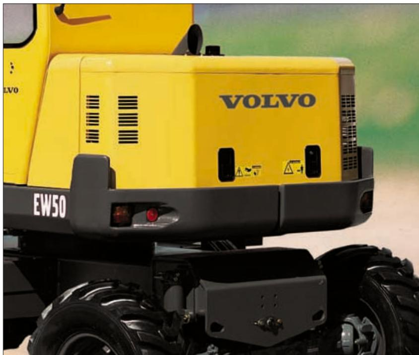
La forma avvolgente del contrappeso protegge perfettamente la parte posteriore della macchina e permette di operare nei cantieri più stretti.
