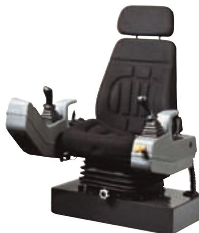
Le console laterali che portano i manipolatori sono solidali alla sospensione del sedile : la precisione della guida è indipendente dai movimenti della macchina e l'operatore è sicuro di trovare una posizione di guida idealmente adatta alla sua morfologia.
