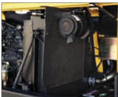
I radiatori del motore e del circuito idraulico vengono collocati fianco a fianco onde facilitarne la pulitura. La batteria ed il filtro ad aria sono anch'essi accessibili con grande facilità.
