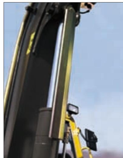
Tubazioni munite di super guaina (sicurezza per l'operatore), centrate a livello del braccio: accessibilità, manutenzione agevolata, migliore visibilità e sicurezza di impiego (senza rischi di agganciamenti). Il braccio è montato su un giunto articolato a doppia forcina che permette il montaggio di un perno lungo e assicura una maggiore rigidità all'accoppiamento braccio-telaio. Il perno del martinetto del braccio è integralmente protetto contro gli urti eventuali da una blindatura robusta.
