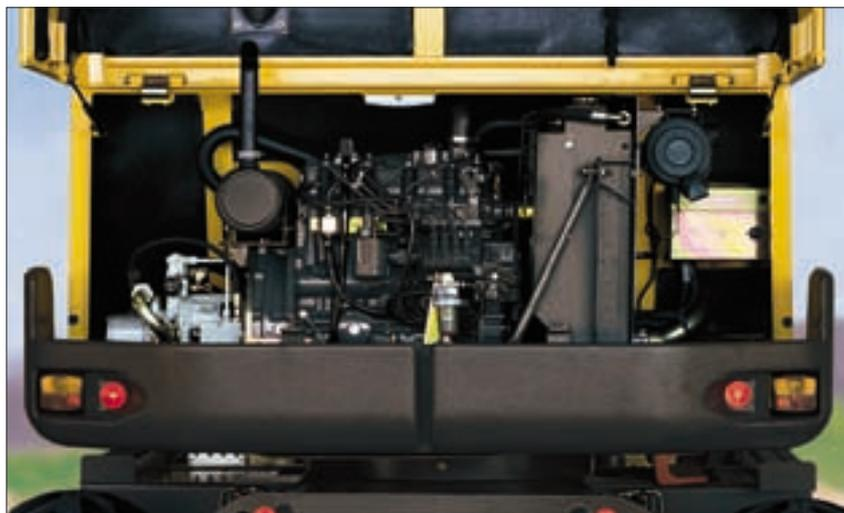
Le large capot insonorisé à ouverture totale offre une excellente accessibilité au moteur : tous les points d'entretien et de vérification tombent sous la main pour gagner du temps. La capacité du réservoir gasoil permet une très grande autonomie d'utilisation.
