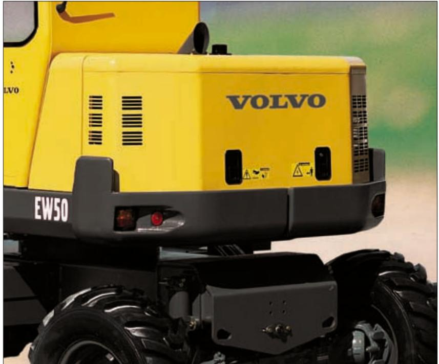
Parce que certains chocs sont malheureusement inévitables, le contre poids enveloppant protège l'arrière de la machine. Le capot en acier est monté en retrait par rapport au contre poids pour améliorer sa protection.
