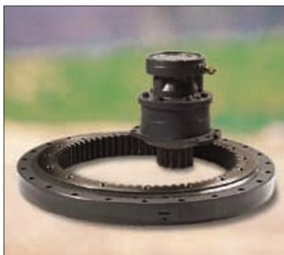
Une exclusivité : le moteur d'orientation lent à pistons radiaux. Ce moteur dispose d'un très fort couple au démarrage, pour des manoeuvres tout en souplesse et entraîne directement la couronne sans réducteur mécanique. Résultat : moins de pièces en mouvement et donc moins de risques d'usure. Le frein hydraulique automatique intégré au moteur d'orientation immobilise la tourelle dans toutes les positions et garantit une sécurité de travail optimale même en dévers.
