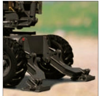
L'EW50 est équipée en standard d'une robuste lame actionnée par deux vérins pourvus de clapets de sécurité. Celle-ci peut être remplacée en option par deux stabilisateurs commandés séparément sur lesquels peut être ajoutée une lame amovible.
