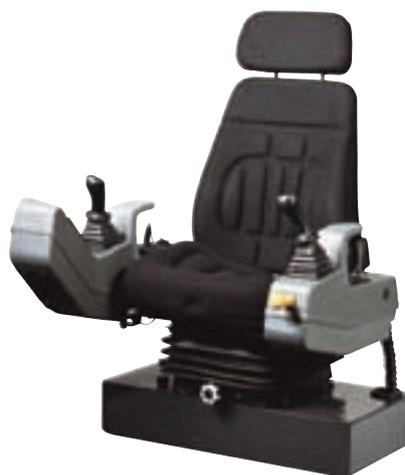
Les consoles latérales portant les manipulateurs sont solidaires de la suspension du siège : la précision de conduite est indépendante des mouvements de la machine et le conducteur est sûr de trouver une position de conduite idéalement adaptée à sa morphologie.
