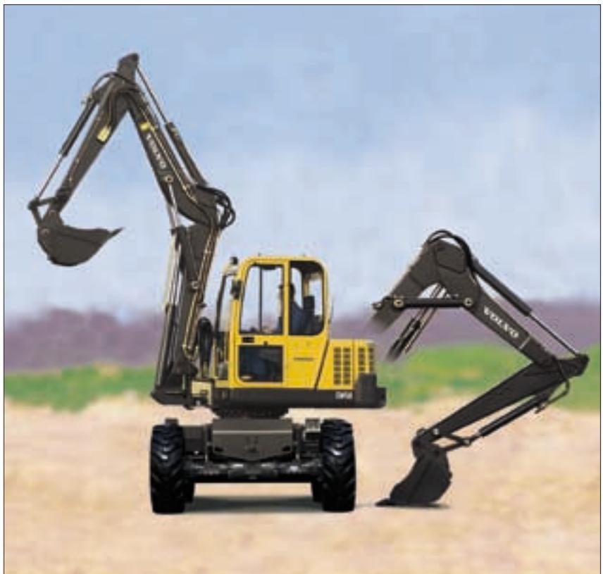
La flèche à volée variable renforce la polyvalence de l'EW50. L'articulation supplémentaire de la flèche permet de réduire l'encombrement de l'équipement et de positionner le godet sur une plus grande surface au sol, même à proximité immédiate de la machine.
