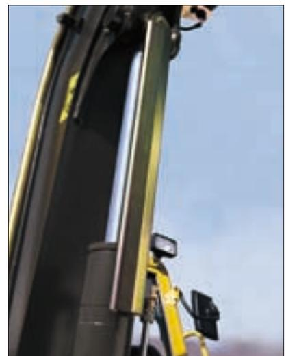
Tous les flexibles de l'équipement sont libres et gainés donc sans frottement ni usure et sont raccordés en pied de flèche pour un remplacement très rapide si nécessaire. La flèche est montée sur un pivot articulé à double chape qui permet le montage d'un axe long et assure une plus grande rigidité de la liaison flèche-châssis. La tige du vérin de flèche est intégralement protégée contre les chocs éventuels par un robuste blindage.
