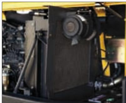
Les radiateurs du moteur et du circuit hydrauliques sont placés côte à côte pour faciliter leur nettoyage. La batterie et le filtre à air sont eux aussi très facilement accessibles.
