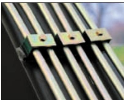
Une protection très efficace contre la corrosion : toute la boulonnerie, les axes et les tuyaux hydrauliques sont zingués et bichromatés.
