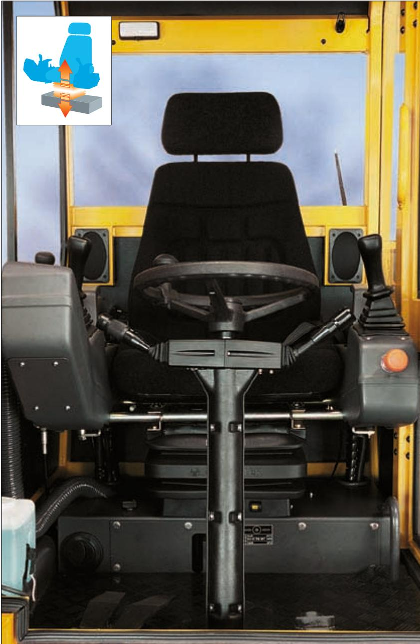
Ergonomisch geformte Bedienungshebel: großer Zeitgewinn, da man die Maschine sehr gut im Griff hat und alle Bewegungen sehr präzise sind. Gefederter und vielfach verstellbarer Komfortfahrersitz, Einstellungen unabhängig zu den Bedienelementen.
