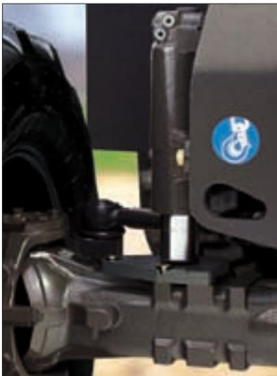
Die Lenkachse ist als Pendelachse, mit einem Weg von 15° ausgelegt, hiermit werden auch schwerste Geländebedingungen gemeistert. Die hydraulische Blockierung der Pendelachse sorgt für Stabilität in allen Stellungen.
