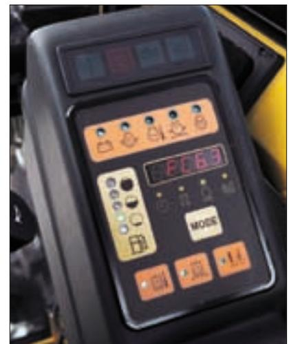
Der in den EW50 integrierte Bordcomputer PUMA überwacht ständig alle wesentlichen Maschinenfunktionen und informiert den Fahrer unverzüglich im Falle einer Störung. Der Fahrer kann durch diese automatische Kontrolle seine gesamte Aufmerksamkeit auf die Bedienung der Maschine richten.
