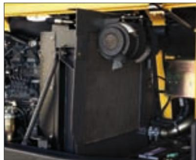
Die Kühler des Hydromotors und hydraulischen Kreislaufs befinden sich nebeneinander, um die Reinigung zu erleichtern. Die Batterie und der Luftfilter sind ebenfalls sehr leicht zugänglich.
