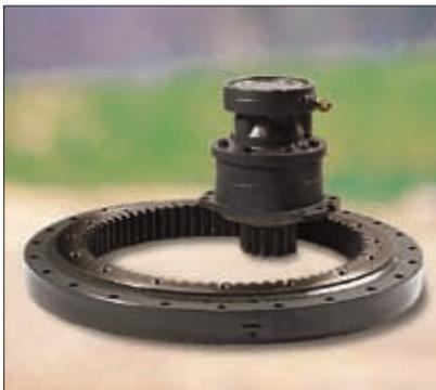
Der Drehwerkmotor mit Radialkolben verfügt über ein sehr hohes Anlaufdrehmoment, welches flexibles Schwenken ermöglicht, und treibt den Kugeldrehkranz direkt und ohne zwischengeschaltetes Reduktionsgetriebe an. Folge: weniger Verschleiß, da weniger bewegliche Teile. Die in den Drehwerkmotor integrierte Bremse blockiert den Oberwagen in jeder gewünschten Position und garantiert eine optimale Arbeitssicherheit, selbst in Schräglage.
