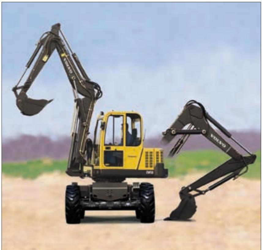
Durch das zusätzliche Auslegergelenk wird der Raumbedarf der Ausrüstung reduziert, und der Löffel kann auf einer größeren Bodenfläche und in unmittelbarer Nähe der Maschine plaziert werden.
