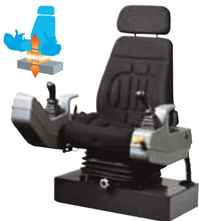
Les consoles latérales portant les manipulateurs sont solidaires de la suspension du siège : la précision de conduite est indépendante des mouvements de la machine et le conducteur est sûr de trouver une position de conduite idéalement adaptée à sa morphologie.
