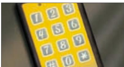
Un clavier antivol, disponible en option, permet de bloquer le démarrage de la machine et les principales fonctions hydrauliques.
