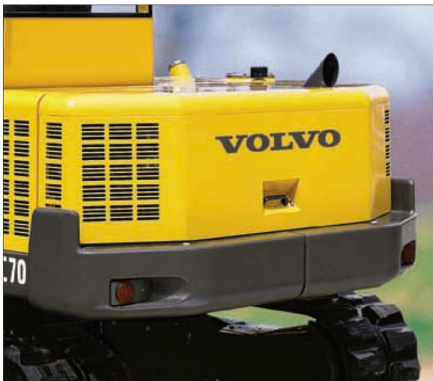
La forme enveloppante du contrepoids protège parfaitement l'arrière de la machine et permet de travailler sur les chantiers les plus étroits.
