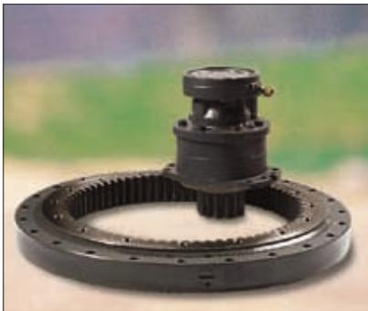
Une exclusivité : le moteur d'orientation lent à pistons radiaux. Ce moteur dispose d'un très fort couple au démarrage, pour des manoeuvres tout en souplesse et entraîne directement la couronne sans réducteur mécanique. Résultat : moins de pièces en mouvement et donc moins de risques d'usure. Le frein hydraulique automatique intégré au moteur d'orientation immobilise la tourelle dans toutes les positions et garantit une sécurité de travail optimale même en dévers.
