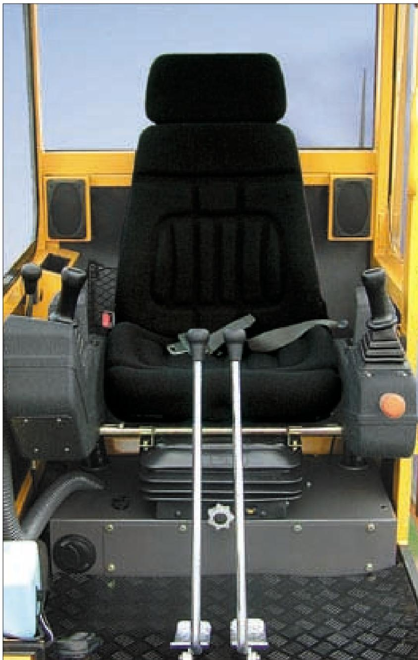
Les commandes hydrauliques sont assistées et très progressives pour plus de souplesse et de précision. Les manipulateurs ergonomiques Volvo tombent bien en main et sont complétés dans leur prolongement par des accoudoirs latéraux qui assurent une position de conduite naturelle et très confortable.
