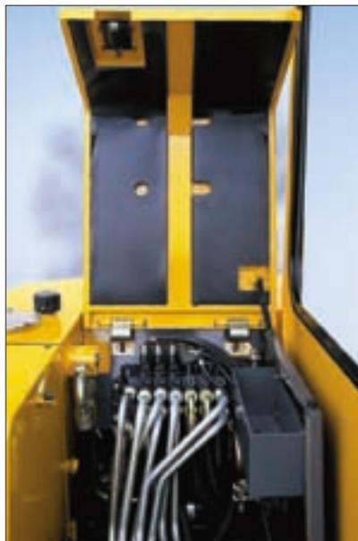
Un large capot central dégage une plate-forme de service où sont regroupés tous les composants hydrauliques de la machine. L'accès aux distributeurs, au joint tournant et au moteur d'orientation est immédiat, ce qui facilite grandement toutes les opérations de maintenance.
