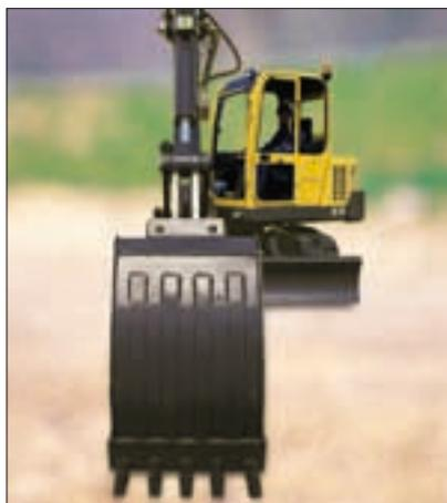
Grâce à ses dimensions compactes et au déport hydraulique de la flèche, l'EC70 est à l'aise dans toutes les configurations de chantiers, même le long d'un mur. La visibilité sur l'équipement est excellente, à gauche comme à droite.
