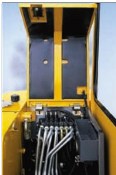
Eine breite Haube ermöglicht den Zugang zu allen zentral angeordneten hydraulischen Elementen der Maschine. Der Steuerblock, die Drehdurchführung und der Drehwerkmotor sind unmittelbar zugänglich, hierdurch sind sämtliche Wartungs- und Einstellarbeiten einfach auszuführen.
