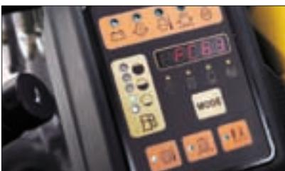
Der in den EC70 integrierte Bordcomputer PUMA überwacht ständig alle wesentlichen Maschinenfunktionen und informiert den Fahrer unverzüglich im Falle einer Störung. Der Fahrer kann durch diese automatische Kontrolle seine gesamte Aufmerksamkeit auf die Bedienung der Maschine richten.
