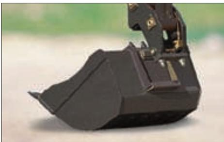
Das Werkzeug-Schnellwechselsystem, das ein Auswechseln des Zubehörs ohne verlassen des Führerstandes ermöglicht: Von allen Benutzern sehr geschätzt, bietet diese Vorrichtung einen beachtlichen Zeitgewinn und ein Plus an Komfort, ohne die Kinematik und damit die Leistung des Löffels zu beeinträchtigen.
