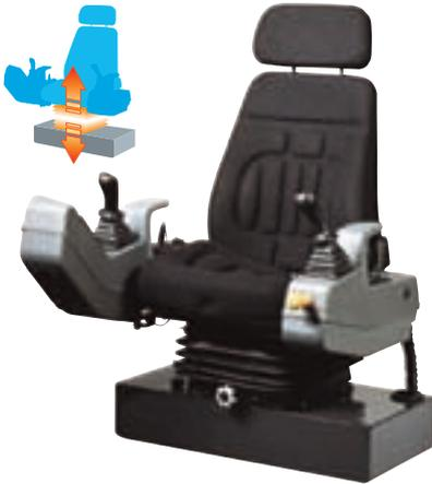
Die Armlehnen mit den Steuerhebeln bilden eine Einheit mit der Sitzlagerung: Die Bedienungspräzision ist damit unabhängig von den Bewegungen der Maschine, der Fahrer kann eine Bedienungshaltung einnehmen, die ein ermüdungsfreies Arbeiten ermöglicht.
