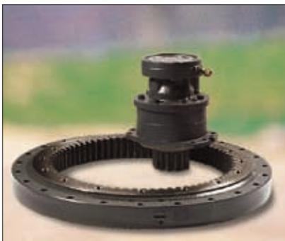
Der Drehwerkmotor mit Radialkolben verfügt über ein sehr hohes Anlaufdrehmoment, welches flexibles Schwenken ermöglicht und treibt den Kugeldrehkranz direkt und ohne zwischengeschaltetes Reduktionsgetriebe an. Folge: weniger Verschleiß, da weniger bewegliche Teile. Die in den Drehwerkmotor integrierte Bremse blockiert den Oberwagen in jeder gewünschten Position und garantiert eine optimale Arbeitssicherheit, selbst in Schräglage.
