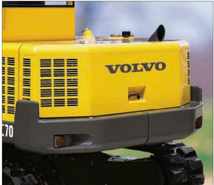
Das umlaufende, überstehende Kontergewicht schützt die Motorhaube sicher gegen Beschädigungen durch Schlag und Stoß.
