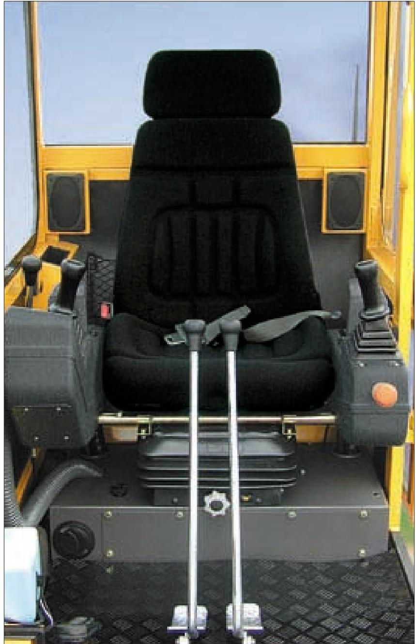
Ergonomische geformte Bedienungshebel: großer Zeitgewinn, da man die Maschine sehr gut im Griff hat und alle Bewegungen sehr präzise sind. Gefederter und vielfach verstellbarer Komfortfahrersitz, Einstellungen unabhängig zu den Bedienelementen.
