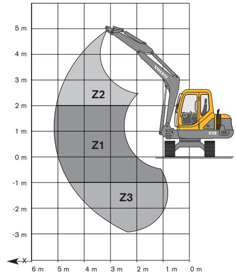
Capacité de levage en position longitudinale et en appui sur la lame.
