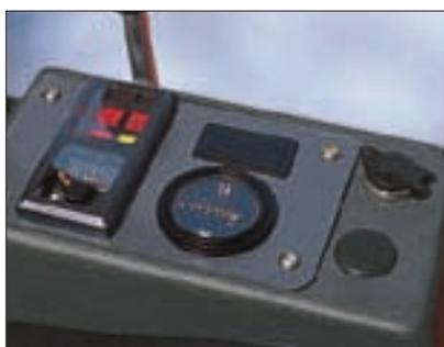
El tablero incorpora un nivel de carburante, contador horario y testigos de presión de aceite, temperatura del agua y carga de la batería. Una toma de corriente permite conectar una lámpara a móvil.
