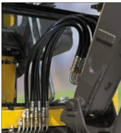
Todos los latiguillos del equipo quedan libres y protegidos por fundas, evitándose de este modo los roces y desgastes, y al estar empalmados a nivel del pie de pluma, su sustitución, en caso de necesidad, resulta muy rápida.
