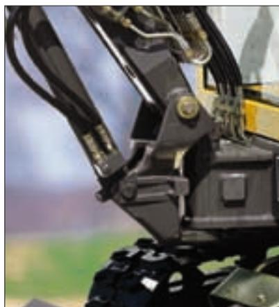
Pivote de amplias dimensiones montado en un eje largo para mayor rigidez, cilindros ampliamente dimensionados, protecciones reforzadas : la resistencia Volvo hasta en los más mínimos detalles para trabajar en las condiciones más extremas.
