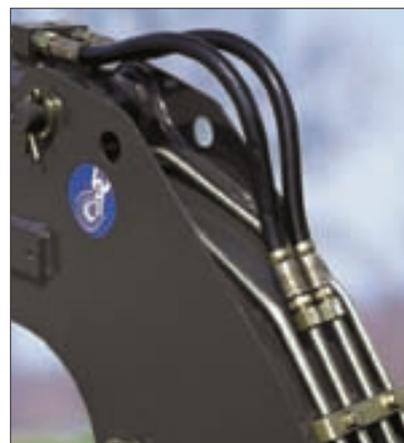
Todos los tubos, ejes y tornillería Volvo están galvanizados para resistir a la corrosión. De cara a una protección óptima, los tubos van montados en la parte superior de la pluma.
