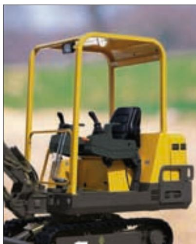
La cabina ed il canopy della EC14 beneficiano di un altissimo livello di sicurezza, garantito dalle certificazioni FOPS 1 (protezione contro le cadute di oggetti), ROPS e TOPS (protezione contro il ribaltamento). La cintura di sicurezza fa parte dell'attrezzatura standard.
