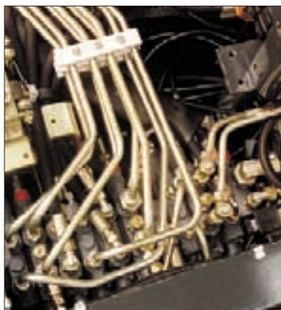
Il blocco di distribuzione è in posizione ideale nella parte anteriore della macchina per un accesso immediato e facile. Tutti i circuiti sono equipaggiati con punti di rilevamento di pressione al fine di accelerare le operazioni di diagnostica in caso di anomalie.
