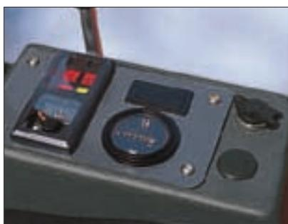
Il cruscotto contiene l'indicatore di livello del carburante, l'orologio e le spie di pressione d'olio, di temperatura dell'acqua e di carica della batteria. Una presa elettrica permette di collegare una lampada a mano.
