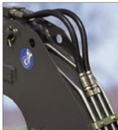
Tutti i tubi, gli assi e la bulloneria Volvo sono zincati e bicromatati per resistere alla corrosione. Per una protezione ottimale, i tubi sono montati sulla parte superiore del braccio.
