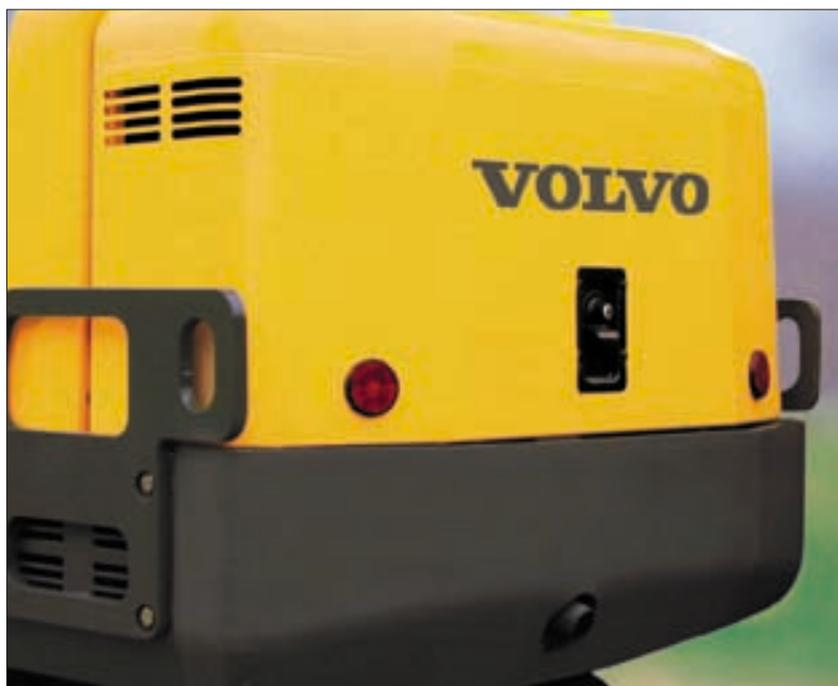
Parce que certains chocs sont malheureusement inévitables, l'arrière de la machine est protégé par le contrepois enveloppant et par de robustes tôles latérales (sur version canopy). Le capot en acier est monté en retrait par rapport au contrepois pour améliorer sa protection.
