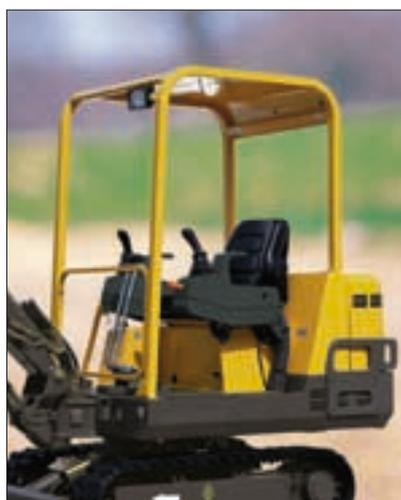
La cabine et le canopy de l'EC14 bénéficient d'un très haut niveau de sécurité, garanti par les certifications FOPS 1 (protection contre les chutes d'objet), ROPS et TOPS (protections contre le renversement). La ceinture de sécurité fait partie de l'équipement standard.
