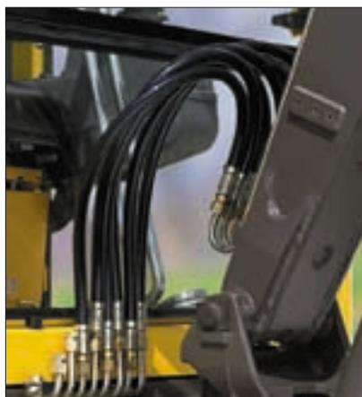
Tous les flexibles de l'équipement sont libres et gainés donc sans frottement ni usure et sont raccordés en pied de flèche pour un remplacement très rapide si nécessaire.
