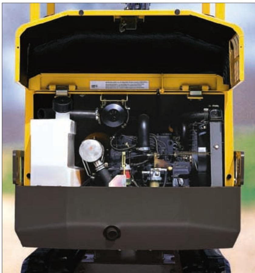
Le large capot à ouverture totale offre une excellente accessibilité au moteur. Tous les points d'entretien et de vérification sont sous la main pour gagner du temps. Le réservoir de gasoil est transparent pour un contrôle rapide du niveau.
