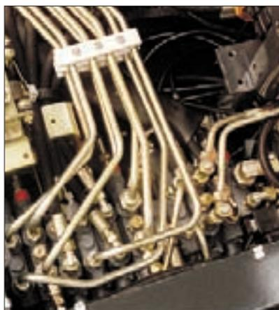
Le bloc de distribution est placé idéalement à l'avant de la machine pour un accès immédiat et facile. Tous les circuits sont équipés de prise de pression pour un diagnostic rapide.
