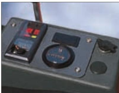
Das Armaturenbrett verfügt über eine Kraftstoffanzeige, einen Betriebsstundenzähler und Lampen für Öldruck, Kühlwassertemperatur und Ladekontrolle. Eine Steckdose zum Anschluß eines Handscheinwerfers ist vorhanden.
