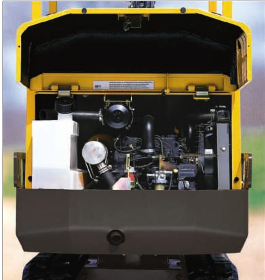
Die große, weit zu öffnende Motorhaube bietet freien Zugang zum Motorinnenraum. Alle Wartungs- und Kontrollpunkte sind einfach zu erreichen, dies erspart Arbeitszeit. Der Dieseltank aus transparentem Kunststoff gewährleistet jederzeit eine genaue Kontrolle des Kraftstoffes.
