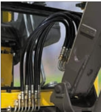
Alle Hydraulikschläuche am Ausleger sind freiliegend und mit einem Schutzschlauch ummantelt; also keine Reibung dadurch keine Abnutzung. Die Schläuche sind am Fuße des Auslegers montiert und können bei Bedarf in kurzer Zeit gewechselt werden.
