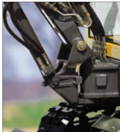
Eine großzügig ausgelegte Lagerung des Auslegers, geführt durch einen langen Bolzen für erhöhte Festigkeit. Zylinder mit großem Durchmesser und Schutzvorrichtungen der Anschlüsse : Volvo Robustheit bis in die kleinsten Details, damit Sie auch mit Ihrem Gerät auch unter extremen Bedingungen sicher arbeiten können.
