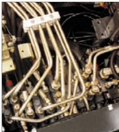
Der Steuerblock befindet sich an der Vorderseite der Maschine : er ist sehr leicht zugänglich. Alle Elemente verfügen über Druckmessanschlüsse um eine rasche Diagnose zu ermöglichen.
