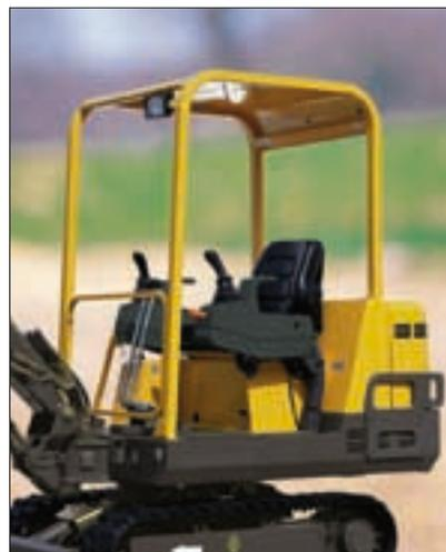
Die Kabine und der überdachte Führerstand des EC14 bieten einen sehr hohen Sicherheitsstandard, der durch die Zertifizierungen FOPS 1 (Schutz vor herabfallenden Gegenständen), ROPS und TOPS (Kippschutz) garantiert wird. Der Sicherheitsgurt gehört zur Standardausstattung.
