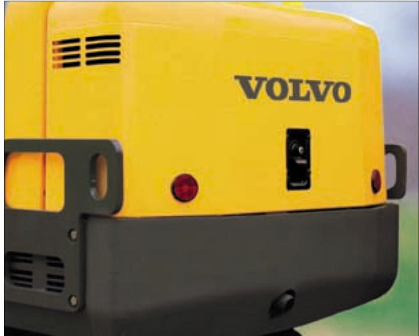
Leider ist es nicht möglich zu vermeiden, daß die Maschinen auf den Baustellen gelegentlich an Hindernisse anstoßen. Um Schäden an der Maschine zu vermeiden wurde das Heckteil der Maschine durch ein umlaufendes Kontergewicht und durch robuste Seitenbleche (nur bei der Ausführung mit Schutzdach) geschützt. Zum Schutze der Motorhaube, wurde diese zum Kontergewicht zurückversetzt montiert.
