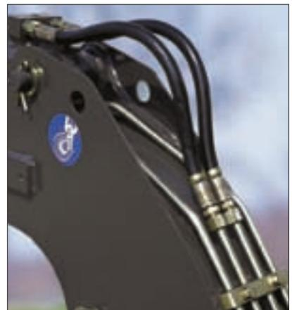
Alle Leitungen, Bolzen und Verschraubungen sind bei Volvo zum Schutz gegen Korrosion verzinkt und bichromatisiert. Zum optimalen Schutz gegen Beschädigungen sind die Leitungen oben auf dem Ausleger montiert.
