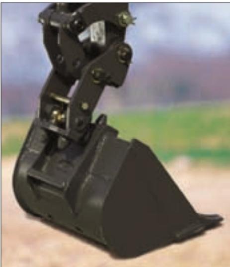
Ein automatische Werkzeugschnellwechsellsystem its als Option erhältlich. Mit diesem System können Anbauwerkzeuge blitzschnell gewechselt werden, wobei die Leistung und Kinematik des Löffels voll erhalten bleibt.
