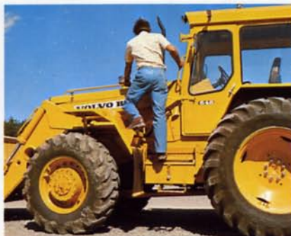
Halkfria fotsteg för säker inspektion
