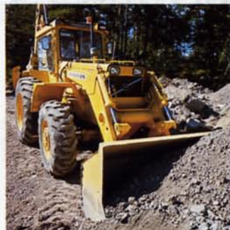
Momentomvandlaren ökar automatiskt inträngningskraften
