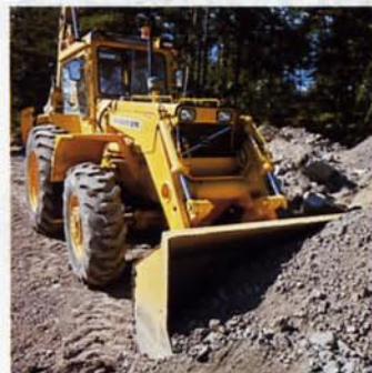
Momentomvandlaren ökar automatiskt inträngningskraften
