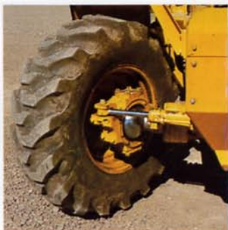
Kraftigt driven framaxel med stora hjul
