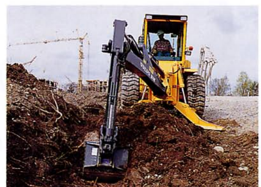
Grävaggreatets avvinkling är helt steglös. Du får bästa grävinkel i alla lägen.
