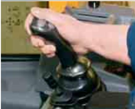
**Control hidráulico con monopalanca\***
