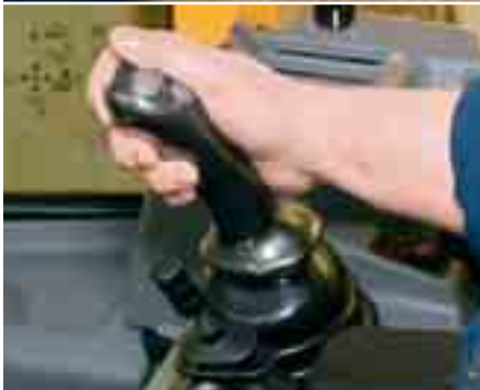
Einhebelbedienung für Arbeitshydraulik*
