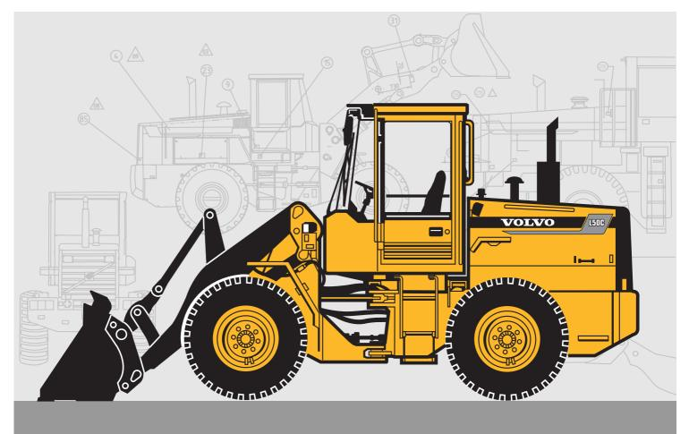
Puissance SAE J1349 : brute 74,6 kW (101 ch) net 71,0 kW (97 ch)
