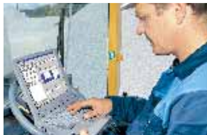
Les données enregistrées indiquent l'état de fonctionnement de la machine. Cette information peut servir de base pour la recherche des pannes et les interventions de maintenance.
