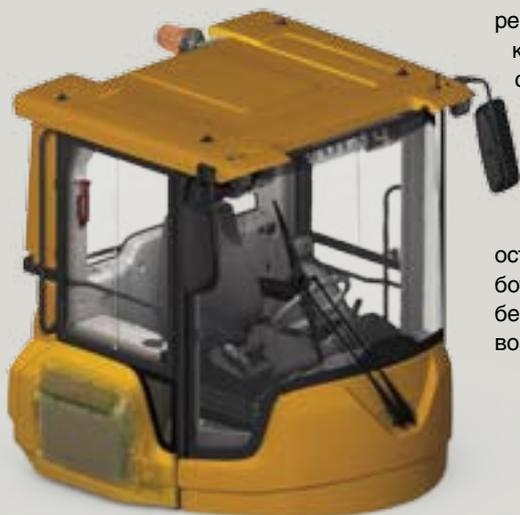
Все кнопки управления сгруппированы на расположенной справа прочной алюминиевой стойке. Полностью регулируемое сиденье позволяет найти оптимальное рабочее положение для оператора любой комплекции. Система управления с подлокотника (CDC)\* совмещает в себе функции рулевого управления и смены направления хода. Её использование позволяет оператору снизить нагрузку на мышцы и повышает производительность.
