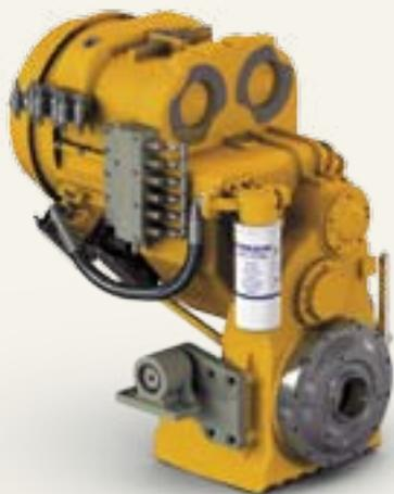
При переключении передач учитываются скорость машины и обороты двигателя. Единственное, что нужно сделать оператору, - выбрать направление хода. APS приспосабливается к текущим рабочим условиям и безошибочно выбирает нужную передачу, позволяя экономить топливо. При нехватке мощности происходит автоматическое переключение на 1-ю передачу.
