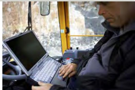
Le programme MATRIS enregistre les données opérationnelles et informe sur le fonctionnement de la machine, ce qui facilite grandement la recherche des pannes et les interventions d'entretien.
